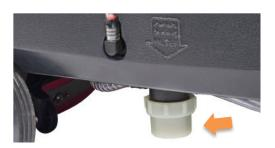
**Une fois par semaine** : Vérifier le filtre de solution et le nettoyer si nécessaire.
