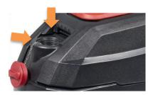
Dévisser le capuchon rouge pour remplir le réservoir d'eau propre et utiliser une température maximale de 40 °C. Ajouter un détergent peu moussant adapté en respectant les instructions de dosage.
