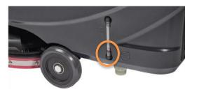
Vérifier le niveau de solution à l'aide de la bille rouge à gauche de la machine.
