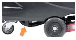
**Tous les jours** : Vider le réservoir d'eau propre en ouvrant le bouchon de vidange situé sous la machine.
