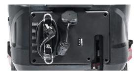
Tous les jours : Charger les batteries : Brancher le câble de charge de la batterie sur la machine et sur la prise murale. Le témoin s'allume en rouge pendant le chargement et en vert à l'issue du chargement.
