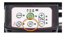
**Tous les jours**: Avec la machine allumée et le plateau remonté, appuyer sur le bouton de désenclenchement pour retirer la brosse/le disque puis le nettoyer ou le vérifier avant utilisation.
