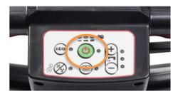
Démarrer la machine et vérifier qu'il y a assez de batterie pour réaliser le nettoyage. Recharger la batterie si nécessaire.
